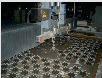
Wasserstrahl- schneiden mit zwei Abrasivschneid- köpfen
